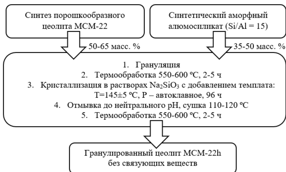
Рисунок 9 – Принципиальная схема получения гранулированного цеолита MCM-22h
