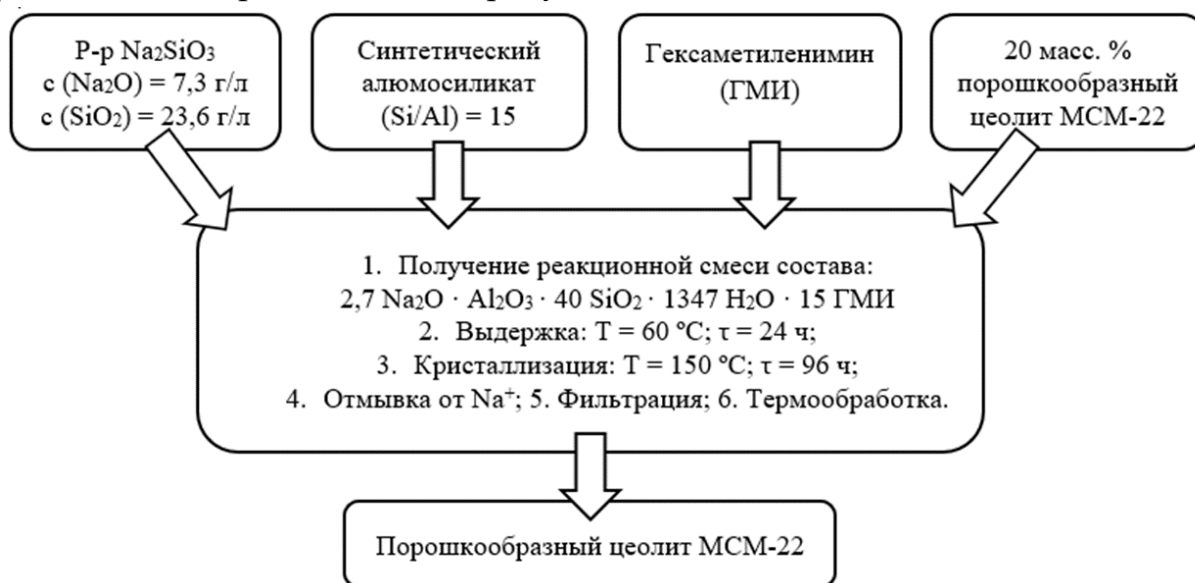
Рисунок 5 – Стадийная схема приготовления порошкообразного цеолита МСМ-22 из синтетического алюмосиликата
