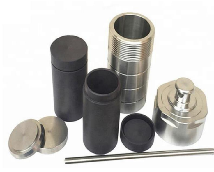
Рисунок 2.1 – Стальные автоклавы со специальным фторопластовым вкладышем
