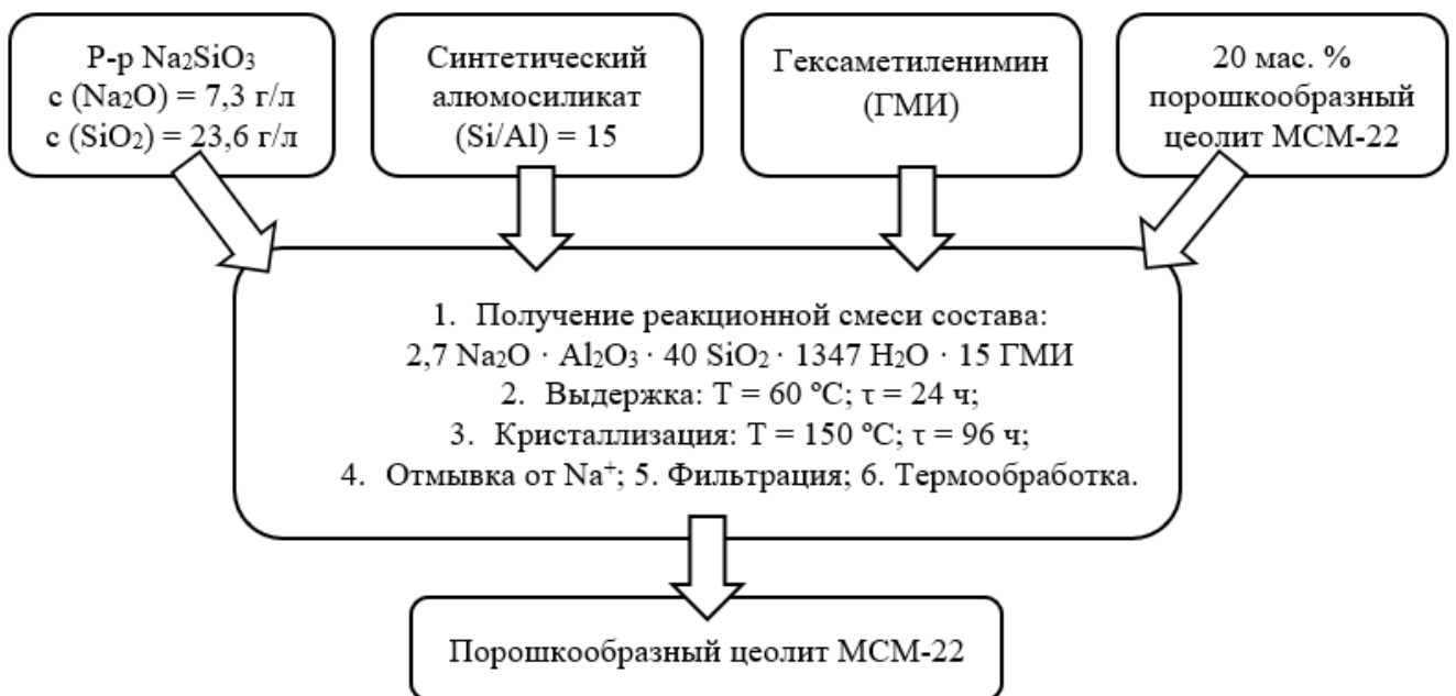
Рисунок 3.21 – Синтез порошкообразного цеолита MCM-22 с использованием синтетического алюмосиликата в качестве источника кремния и алюминия
