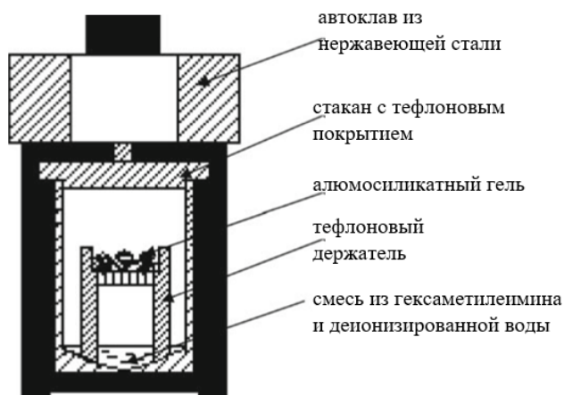
Рисунок 1.21 – Схематическое изображение автоклава, используемого для парофазной кристаллизации
