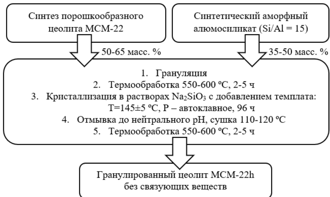
Рисунок 2.1 – Принципиальная схема получения гранулированного цеолита MCM-22h
