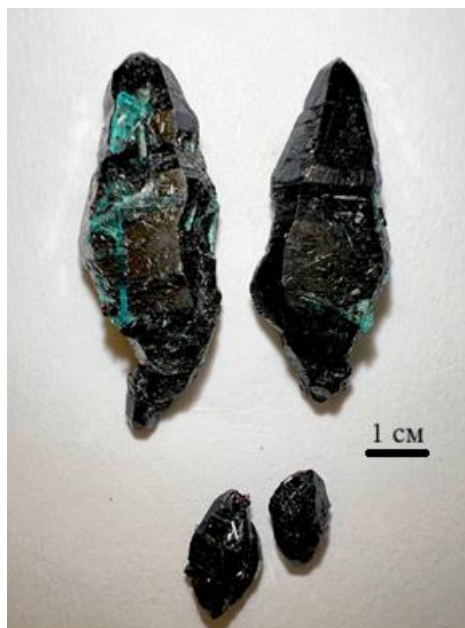
Рисунок 10 – Фотография выращенных кристаллов CsCuCl 3
