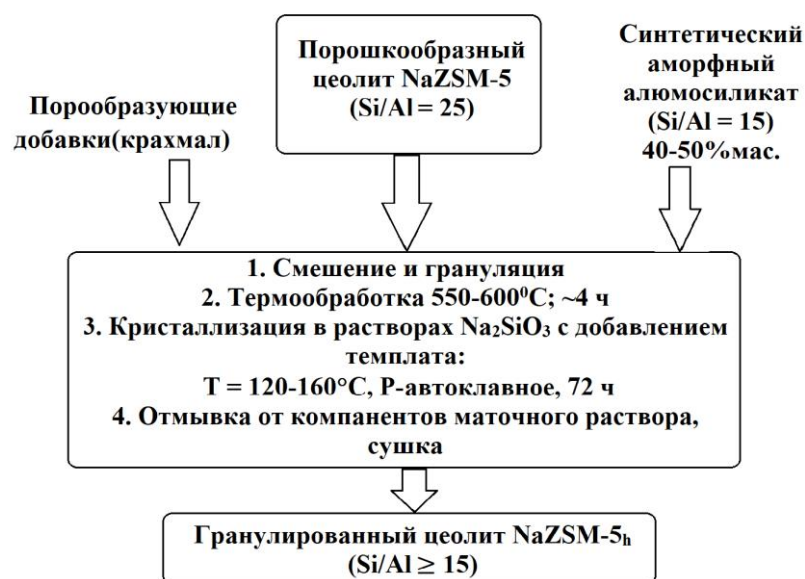
Рисунок 7 - Обобщенная стадийная схема приготовления гранулированного цеолита NaZSM-5h
