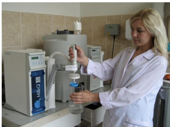
установка ультрачистой воды
