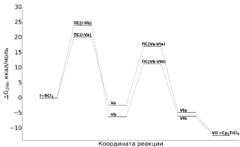
Рисунок 4 – Энергетическая диаграмма реакции переметаллирования 2-этил-титанацклопропана I реагентом \text{BCl}_3
