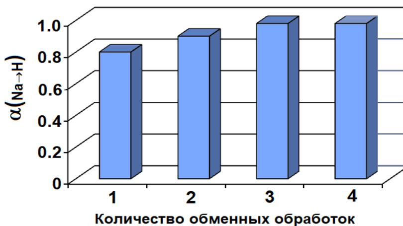
Рисунок 14 – Зависимость степени обмена катионов Na<sup>+</sup> на катионы H<sup>+</sup> ( $\alpha(\text{Na} \rightarrow \text{H})$ ) от количества обменных обработок в образце цеолита ZSM-5<sub>mmmm</sub>
