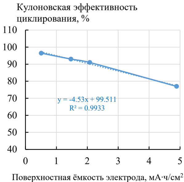
Рисунок 8 – Зависимость кулоновской эффективности циклирования литий-серных ячеек от поверхностной ёмкости положительных электродов (21 цикл).
