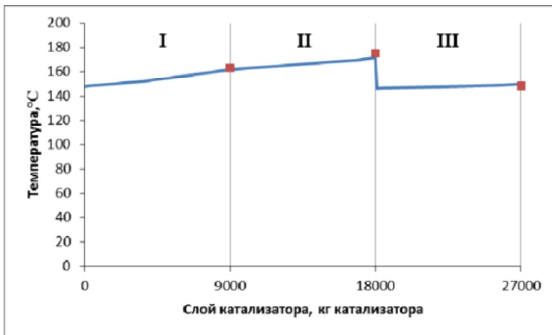
Рисунок 6 – Профиль температур в реакторном блоке.
