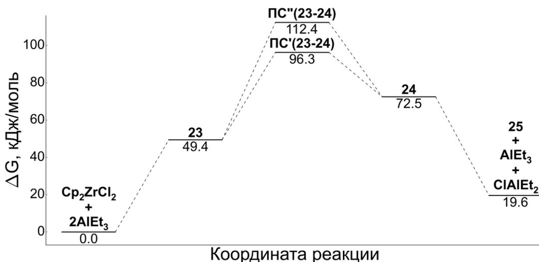
Рисунок 2.19 – Энергетическая диаграмма лигандного обмена между Cp<sub>2</sub>ZrCl<sub>2</sub> и AlEt<sub>3</sub> (энергия невзаимодействующих молекул принята за точку отсчета)
