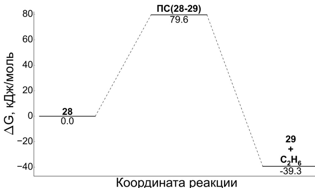
Рисунок 2.21 – Энергетический профиль реакции образования цирконациклопропана **29** через внутримолекулярный  $\beta$ -гидридный перенос в диэтилцирконоцене **28**
